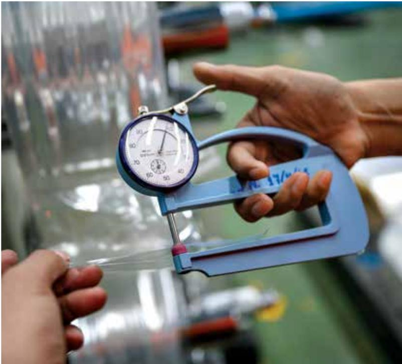
قياس سماكة كيس بلاستيكي من نوع البولي بروبيلين لفحص الجودة والتحكم بها قبل استخدامها في صناعة الأكياس البلاستيكية
